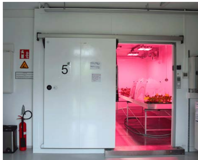
Abb. 2: Die Klimakammer stellt kontrollierte Umweltbedingungen für Pflanzenschutzmittelversuche sicher.
