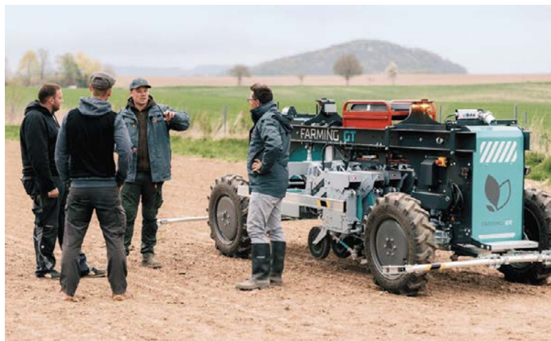
Abb. 2: Der Hackroboter Farming GT (Modellvariante 2022) der Firma Farming Revolution GmbH wird von Mitarbeitern vom IfZ und von KWS Betrieb genommen. Ein Kamerasystem – gekoppelt mit Algorithmen zur Bilderkennung – steuert die Hackwerkzeuge zwischen und in den Reihen (Quelle: KWS SAAT SE & Co. KGaA 2022).
