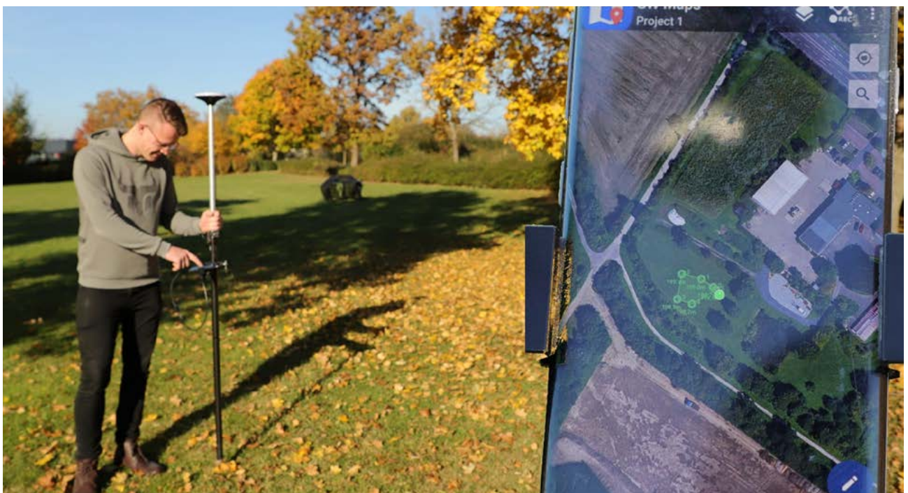
Abb. 1: Mitarbeiter des IfZ mit RTK-Messstabsystem (links), Mobiltelefon mit App zur Verarbeitung der Positionsdaten (rechts).
