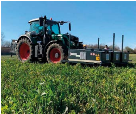
Abb. 1: Electroherb-Technologie im Einsatz: Der Strom wird über einen Generator am Heckanbau des Traktors erzeugt, die Applikationseinheit befindet sich im Frontanbau (Foto: S. Baumgarten/ARGE Nord).
