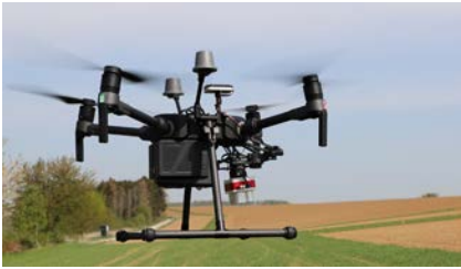
Fliegende Plattformen ermöglichen den Überflug der Felder mit hochauflösenden RGB- und Multispektralkameras. Im Bild ist eine DJI Matrice 210 RTK Drohne mit einer Micasense Altum Multispektralkamera zu sehen.
